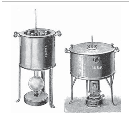
Аппараты Гиппиуса для пастеризации молока (начало XX века). Из книги К.И. Козьминой «Истоки Уральской педиатрии», 2014.
